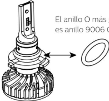
Tipo original 9005, reemplazar a anillo O 9006 para tipo 9006.
