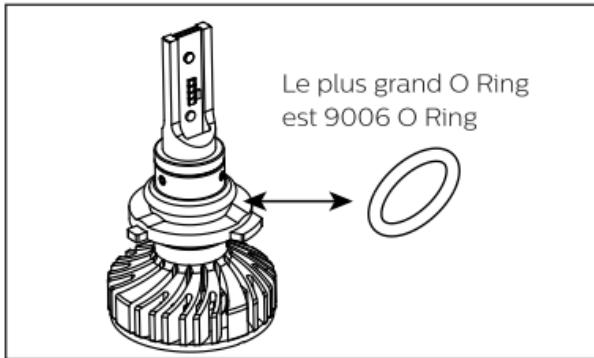
Type 9005 d'origine, remplacer par un anneau torique 9006 pour le type 9006.
